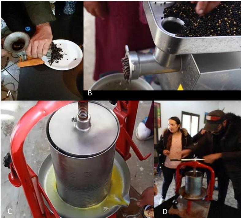
**Figure 11.** Équipements d'extraction modernes : hachoir manuel (A), hachoir électrique (B), presse hydraulique (C), démonstration (D) (Crédits – F. Mezni).
