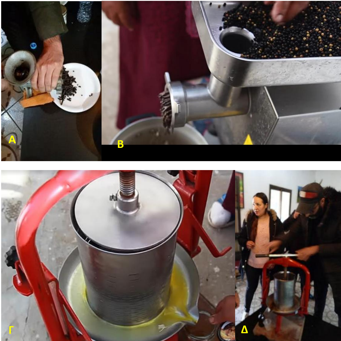
Εικόνα 11. Σύγχρονος εξοπλισμός εξαγωγής: χειροκίνητος κόφτης (Α), ηλεκτρικός κόφτης (Β), υδραυλική πρέσα (Γ), επίδειξη (Δ) (Πηγή – F. Mezni).
